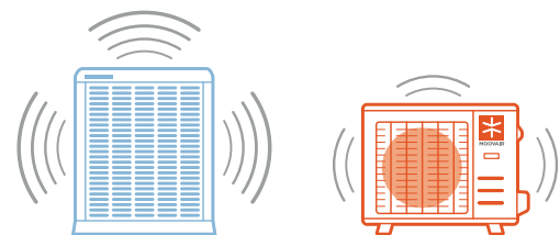
Système central traditionnel: 73 dB(A) Système Central-Moov: 58 dB(A)
